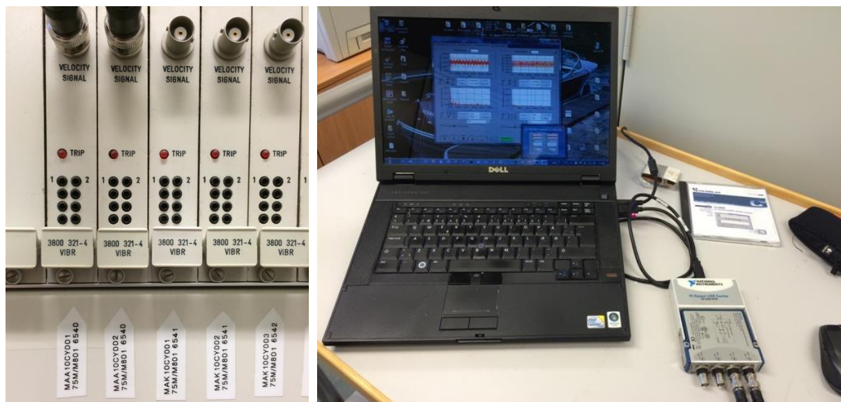
Figur 5-18. Til venstre: Udtag af to vibrationssignaler (de to bokse længst til venstre) for de to turbinelejer. Til højre: Vibrationsoptagelse med CC2000 software fra Colding A/S via analog/digital converter (NI 9234), som er forbundet til de to udtag (på venstre billede).
