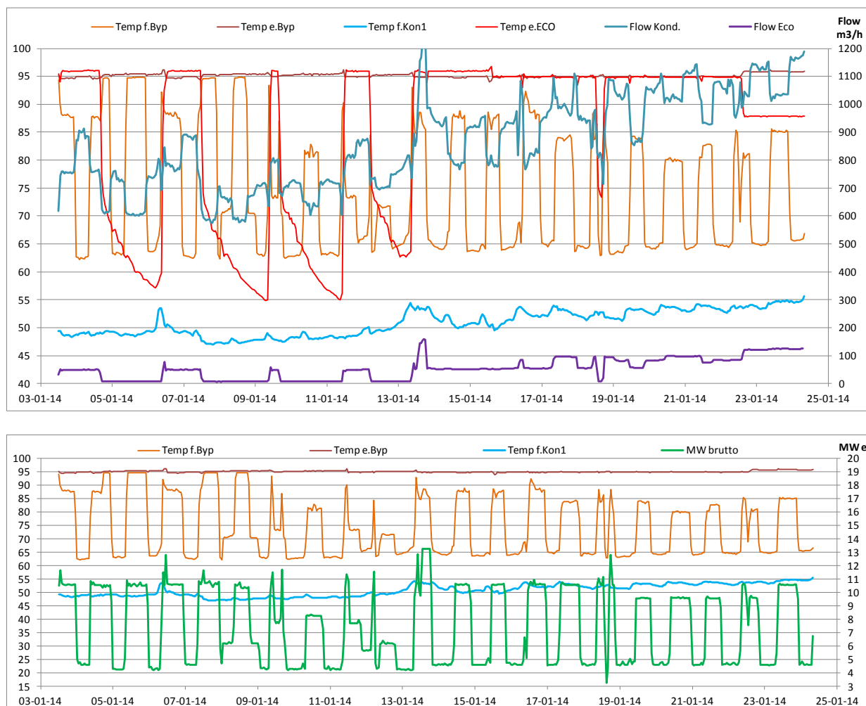
Figur 5-13. Driften i januar 2014, med delvis bypass på turbinen typisk om natten med lave elpriser.
